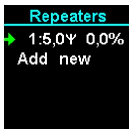
In diesem Fall wird der zusätzliche RP902 in der oberen Zeile als Repeater „1“ angezeigt.
