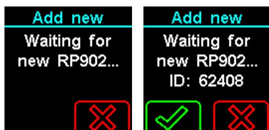
Wenn Sie das gefundene Gerät RP902 hinzufügen möchten, drücken Sie zur Bestätigung **Ent**. Drücken Sie zum Beenden **Esc**.
