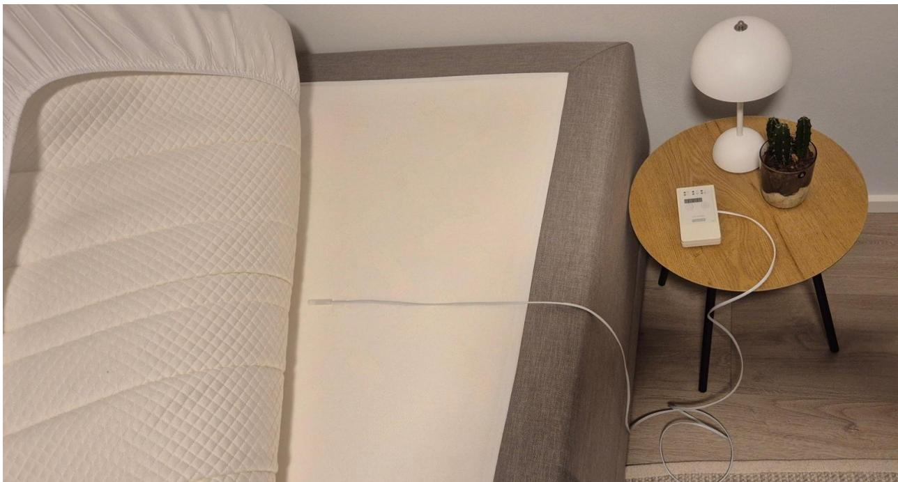
Der externe Sensor wird an das EPI901 angeschlossen und kann z. B. am Ende des Bettes oder wie abgebildet aufgehängt werden.
